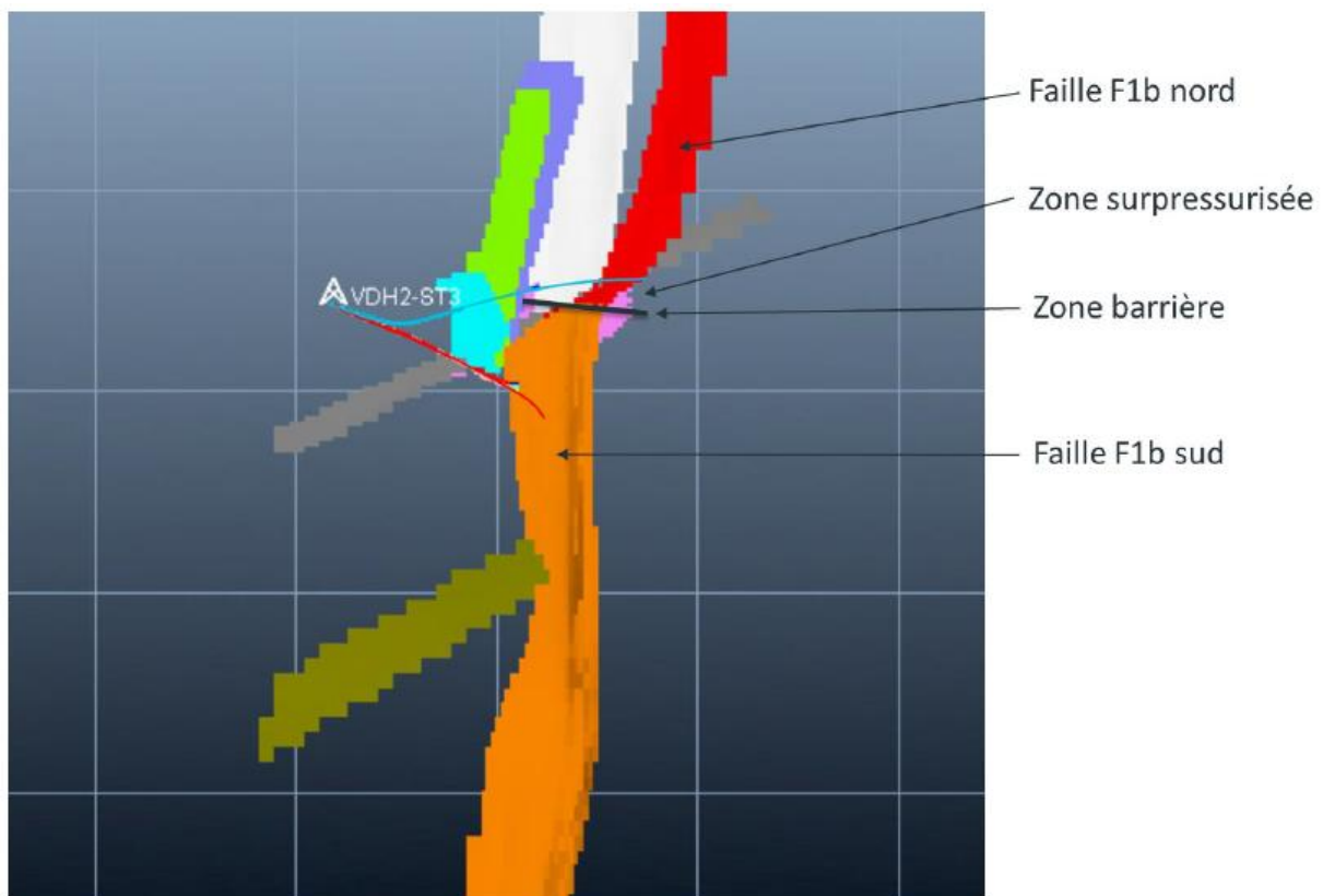
Figure 7, version simplifiée par FONROCHE GEOTHERMIE pour des raisons de propriété industrielle : image conceptuelle du réservoir simplifiée avril 2022 ( Modèle structural de FG, début 2020, vue du dessus (Figure modifié de FG)).
