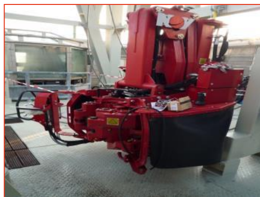
Dispositif d'assemblage des tiges (Iron Roughneck)
