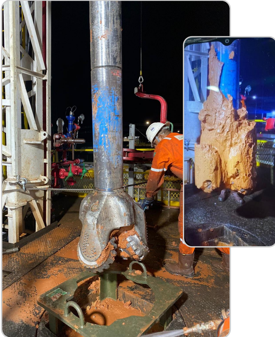
Colonne de forage et tête tricone
