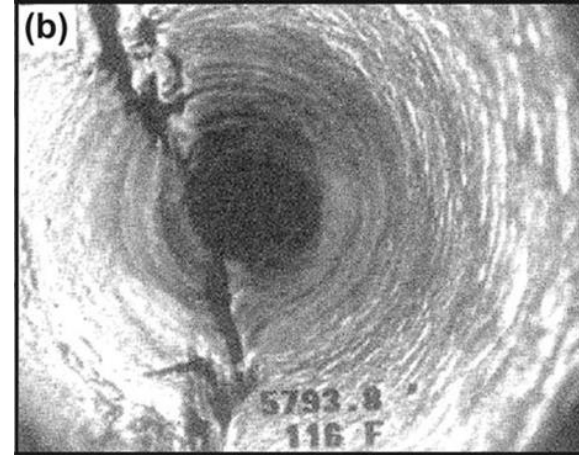
Image d'un trou nu de forage (avec fracture)
