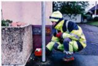
Une employée vérifie que les vibrations ne dépassent pas les seuils autorisés.
