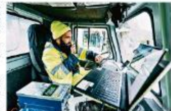
Les chauffeurs des camions font descendre la plateforme vibrante depuis leur cabine.
