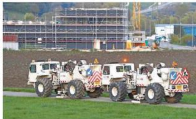
Jeu de scène, les deux camions vibreurs, qui agissent simultanément pour accroître la précision des données, s'en aillent du côté de Deviller et Delémont.
