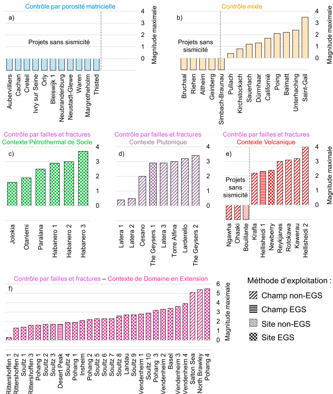
Figure 21 : Sismicité observée en lien avec les cas d'études décrits au Chapitre 4 en fonction du type de système géothermique. Systèmes contrôlés par porosité matricielle (a) ; systèmes à contrôle mixte (b) ; systèmes contrôlés par failles et fractures (CFF) en contexte pétrothermal de socle (c) ; systèmes CFF en contexte plutonique – (d) ; systèmes CFF en contexte volcanique (e) ; système CFF en contexte de domaine en extension (f). Les cas d'études pour lesquels aucune sismicité n'a été observée sont reportés à gauche des histogrammes (figures a, b, e). Pour les cas d'études associés à l'occurrence de sismicité, la barre de l'histogramme indique la valeur de magnitude maximale ( M_{max} ) des séismes observés. Pour tous les cas d'études, la texture de remplissage des histogrammes indique la méthode d'exploitation de la ressource géothermale, comme indiqué dans la légende et décrit en détail en section 4.2.2.
