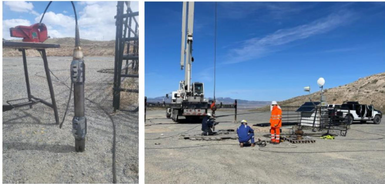
Sismomètres pour la surveillance long terme, Utah FORGE
