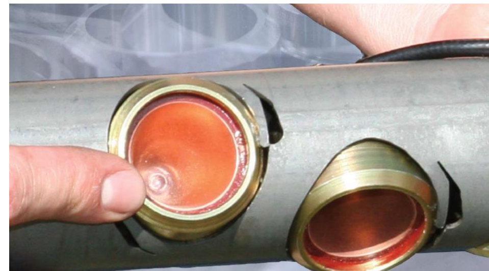
Outil de perforation du tubage avec charges explosives
