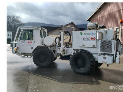
L'entreprise Geo2X a présenté ce samedi matin à Bascourt le modèle de camion vibreur qui servira à faire des mesures géophysiques ces prochaines semaines dans la région jurassienne
